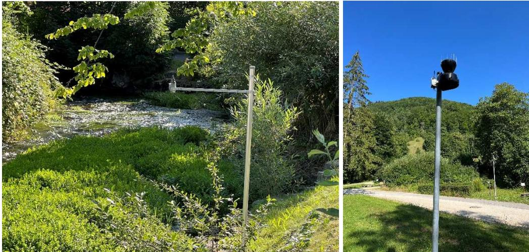
Abb. 7 Beispiele für batteriebetriebene Pegelsensoren oder Regenmesser.
